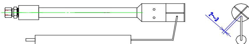
スパーク隙間 2~3mmに調整
