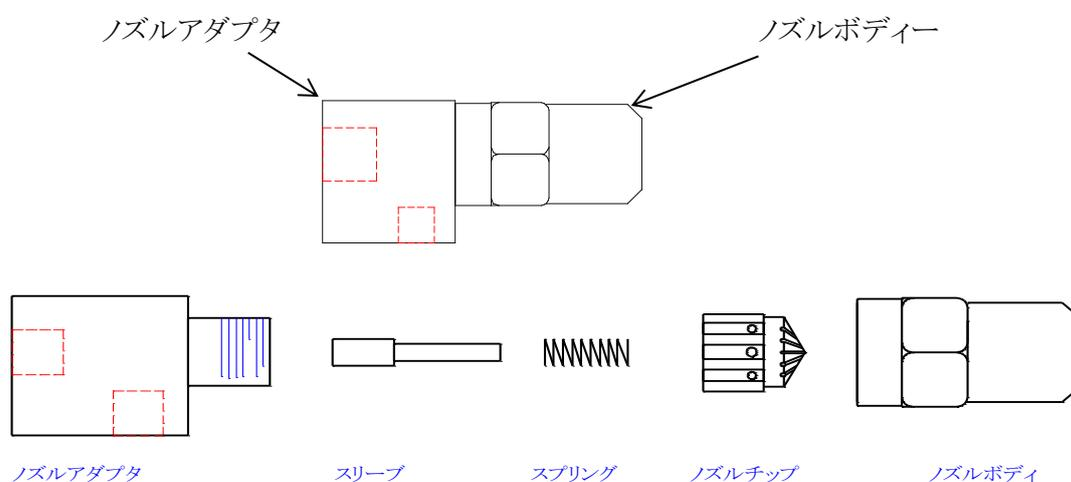
図. 3 ノズルチップ分解図
